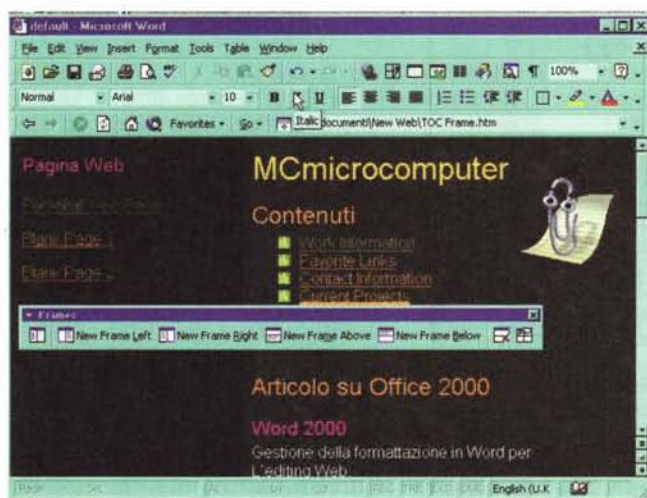
Word come editor HTML: esempio di semplice pagina Web realizzata seguendo l'autocomposizione basata su template. Da notare la barra degli strumenti che consente di gestire i frame all'interno della pagina.
